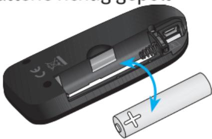
4. Schieben Sie die Abdeckung des Batteriefachs entgegen der Pfeilrichtung zurück.
